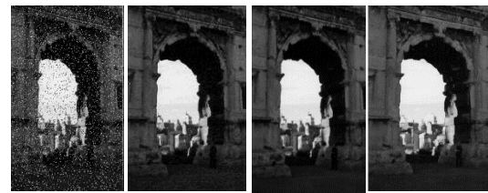
(a) Salt & pepper noise (b) Median Filter (c) Mean Filter (d) Max Filter
